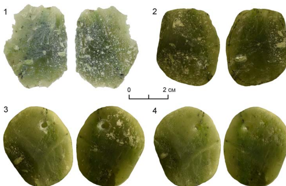
Рис. 2 (фото). Последовательные изменения поверхности нефритовой заготовки в ходе экспериментов по шлифовке и полировке: 1 – заготовка после первого этапа шлифовки в течение 30 мин; 2 – заготовка после второго этапа шлифовки в течение 1,5 ч; 3 – заготовка после третьего этапа шлифовки в течение 3,5 ч; 4 – заготовка после полировки в течение 30 мин (фото автора)
